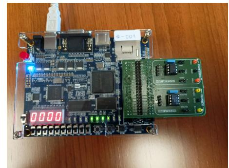
Este proyecto consiste en el diseño y desarrollo de una placa de expansión para los kits de prototipado basados en FPGA DE1 y DE0 de Intel, ampliamente utilizados en las asignaturas de Sistemas Digitales y Sistemas de Comunicación.
